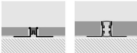
Las pestañas laterales metálicas del perfil tienen un buen agarre bajo el revestimiento.
