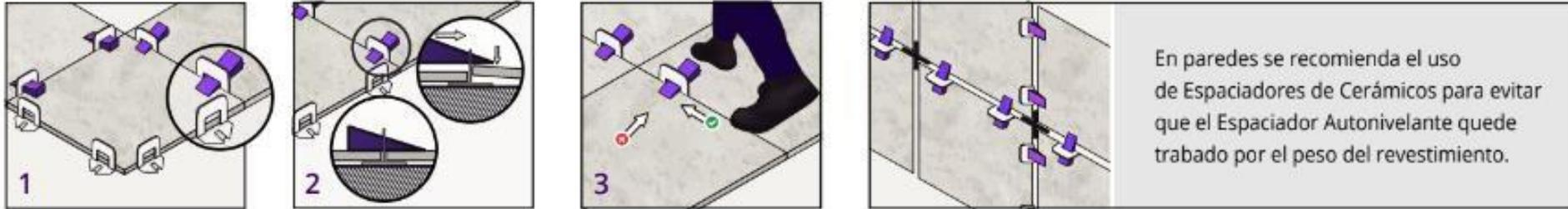
En paredes se recomienda el uso de Espaciadores de Cerámicos para evitar que el Espaciador Autonivelante quede trabado por el peso del revestimiento.
